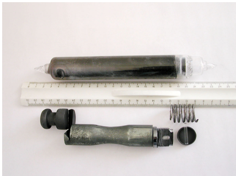
Рис. 4. Элементы конструкции и собранная штатная ампула для проведения КЭ на установке «Полизон»: 1 — держатель; 2 — монокристалл антимонида галлия с выточкой; 3 — пластина арсенида галлия; 4 — пружина; 5 — ограничитель хода; 6 — собранная штатная ампула
