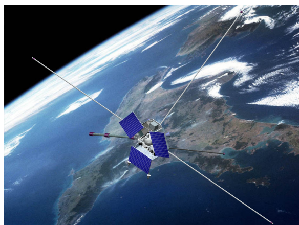
Рис. 2. Вид спутника проекта РЕЗОНАНС с раскрытыми штангами и солнечными панелями
