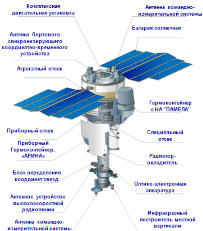
Рис. 2. Схема размещения НА «ПАМЕЛА» на КА «Ресурс ДК1» №1
