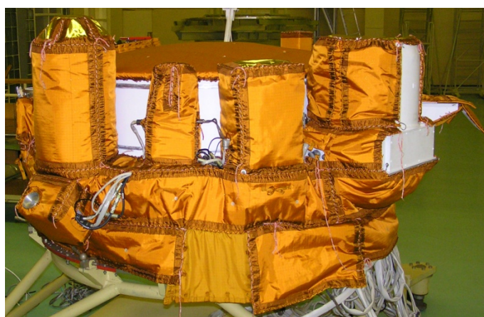
Рис.2 Комплекс детекторов научной аппаратуры на тепловакуумных испытаниях в НИИЭМ под экранно- вакуумной теплоизоляцией.
