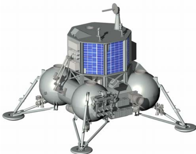
Унифицированный посадочный аппарат для проектов Луна-Глоб и Луна-Ресурс
